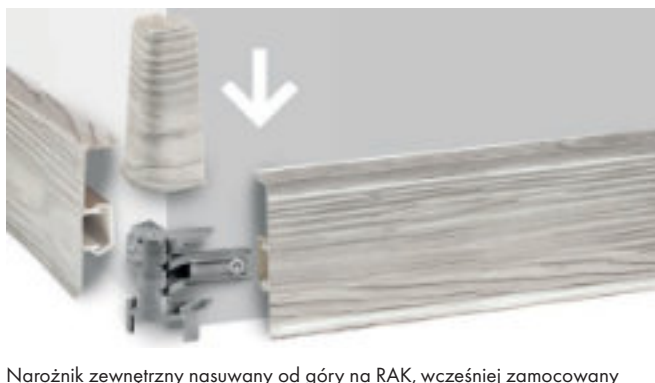
Narożnik zewnętrzny nasuwany od góry na RAK, wcześniej zamocowany wkrętami do ściany. A slipped-on external corner for placing over CRAB from above, which is first fixed to the wall with screws. Die Außenecke wird von oben über das Befestigungselement RAK gesteckt, das zuvor mit Schrauben an der Wand befestigt wurde.
